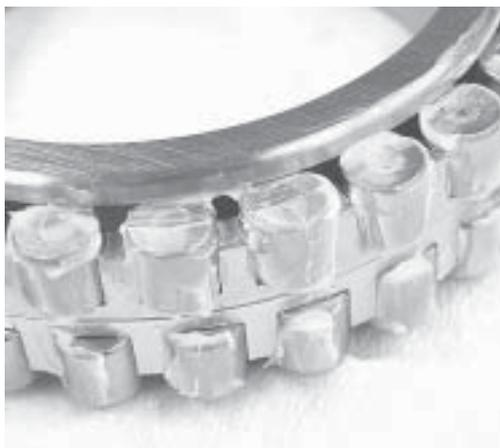
Abb. 5: befestetes Zylinderrollenlager
