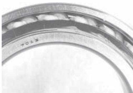
Abb. 4: befestetes Schrägkugellager
